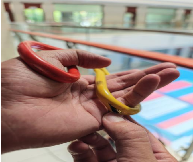
图 16 模拟左手握剪刀胶皮破损位置 与受伤位置吻合
