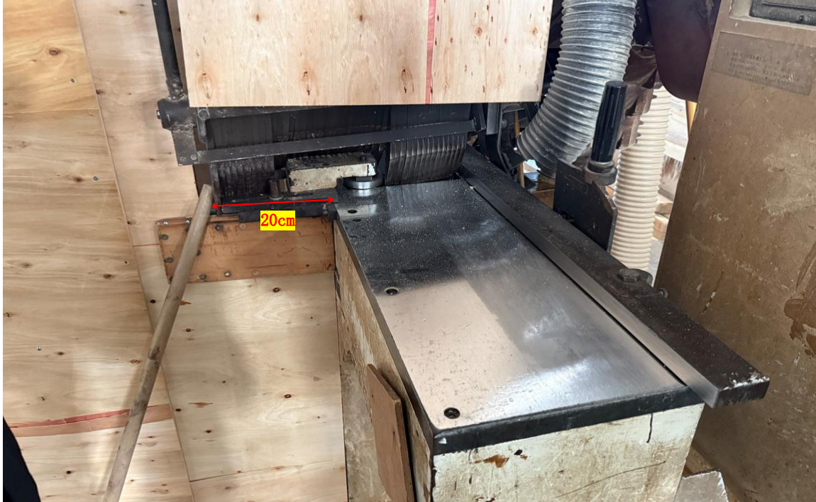
图 9 止逆器突出工作台边缘 20cm
