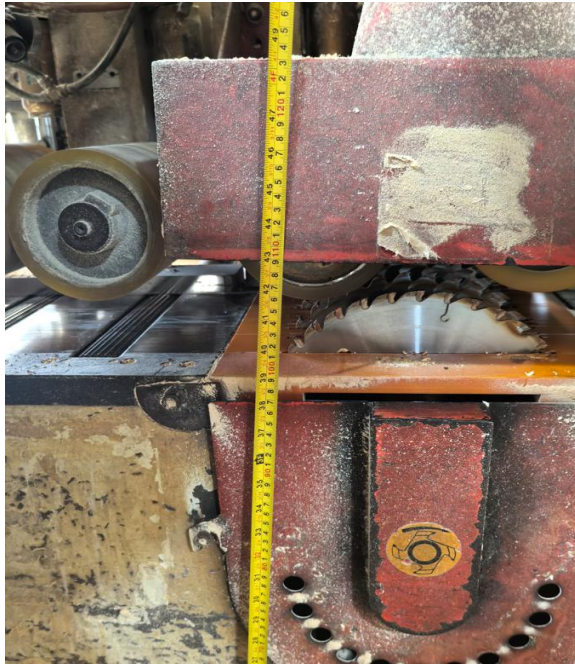
图 5 涉事多片锯工作台高度及工作台与锯片、上辊轮之间的尺寸情况图
