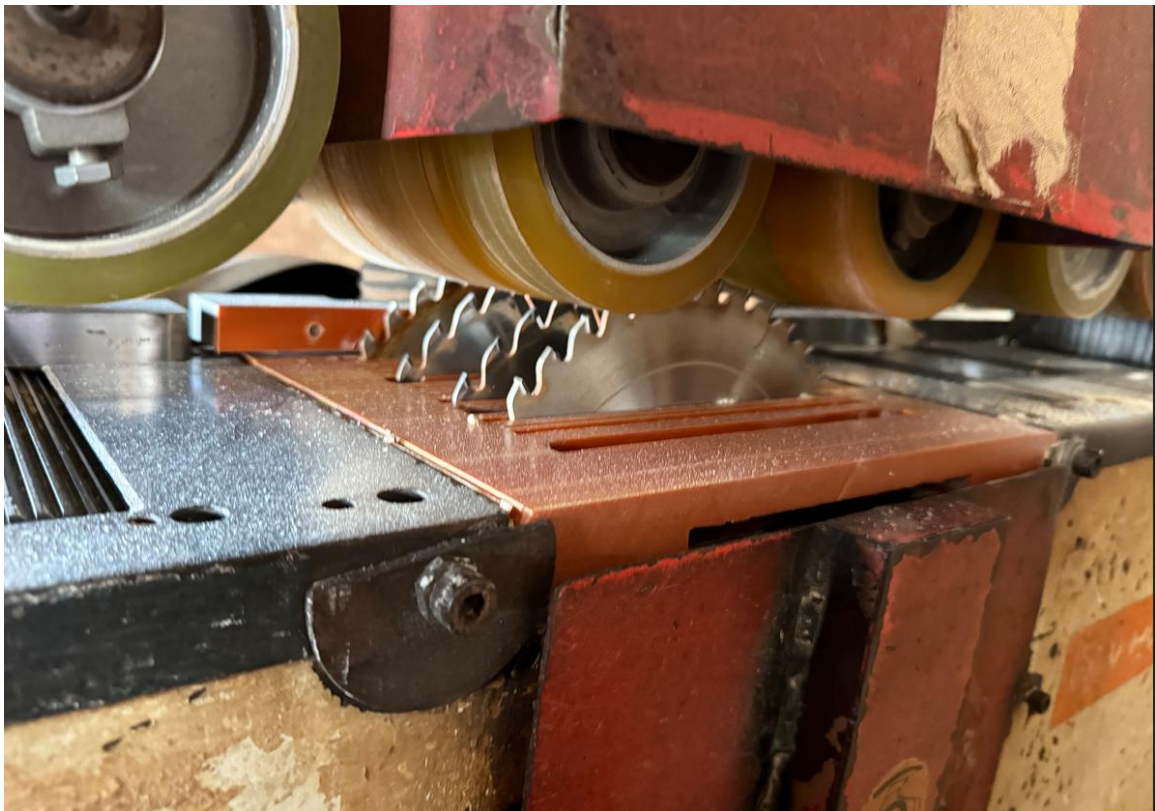
图 6 事发时，涉事多片锯安装 4 张锯片，未配套安装分料刀
