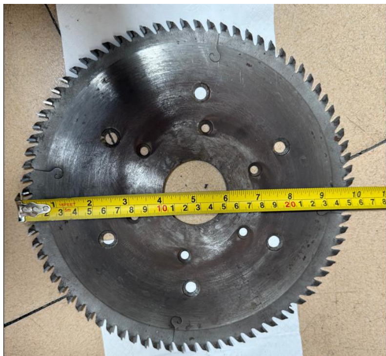
图 7 锯片外圆直径 255mm，内孔直径 50mm
