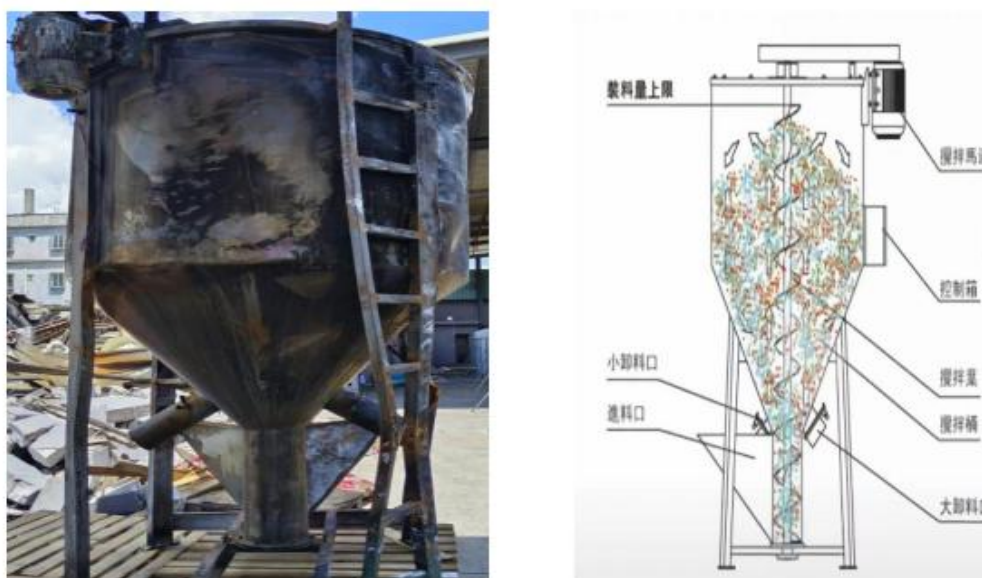
图 1 立式搅拌机及其原理示意图
