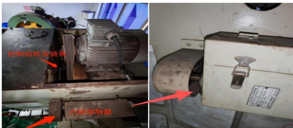
图 5 涉事冲床凸轮控制器现状图
