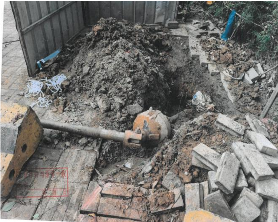
图4 涉事设备的钻杆、钻头
