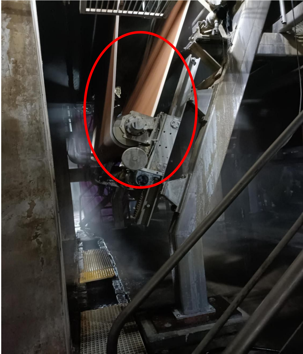
图2 二压下高速转动的毛布和张紧辊
