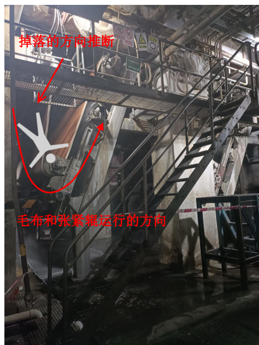
图8 毛布和张紧辊运行方向
