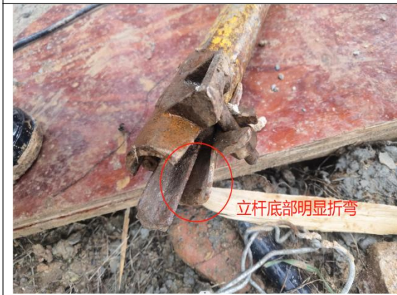
图 6 坠落立杆底部明显折弯
