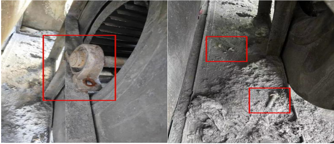
图 8 轴承座固定螺栓松脱掉落
