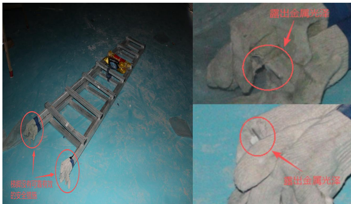
图 11-12 死者作业时所用金属梯
