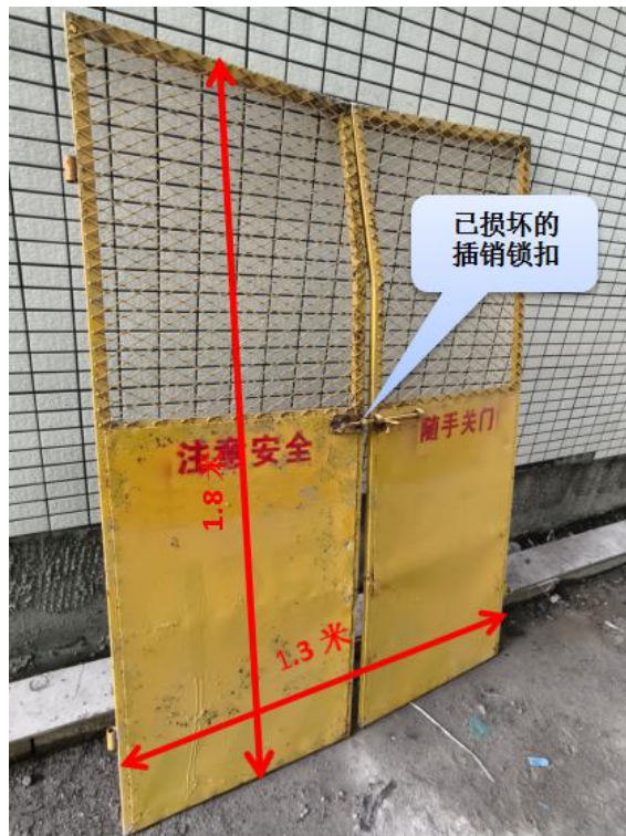
图 8 原 18 层左笼楼层门图
