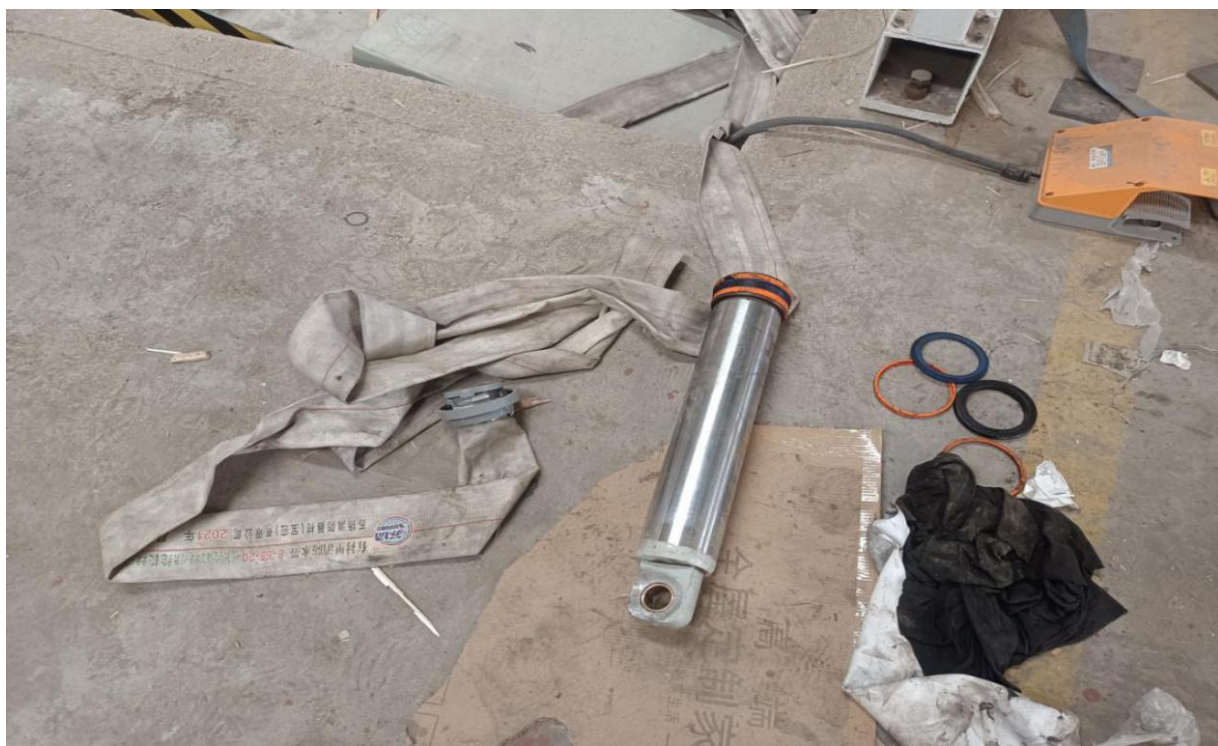
图2 事发现场维修拆卸的液压油缸
