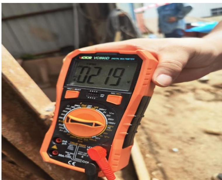
图 10 检测电动机外壳电压
