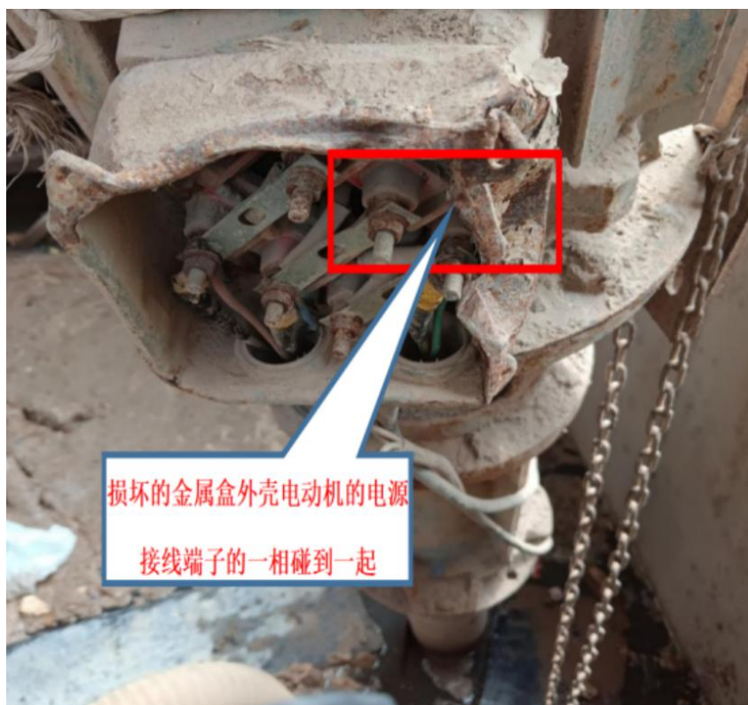
图 2 涉事抽水泵电源接线盒损坏情况
