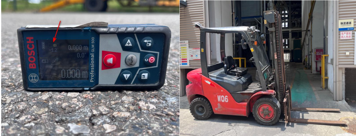
图 6 事故发生侧翻路面坡度和事故叉车斜坡侧停情况
