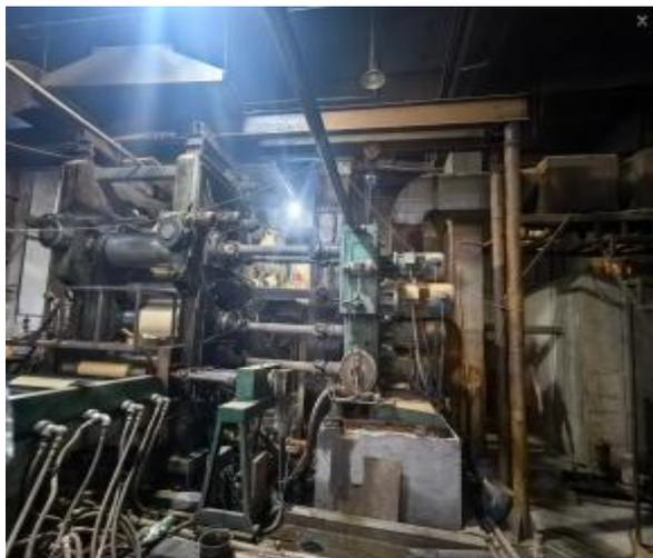
图3 辊塑料压延机
