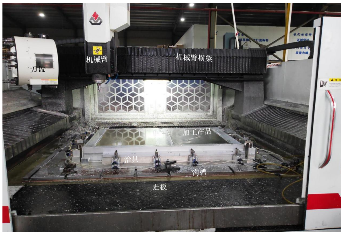
图 3 涉事 CNC 的内部结构
