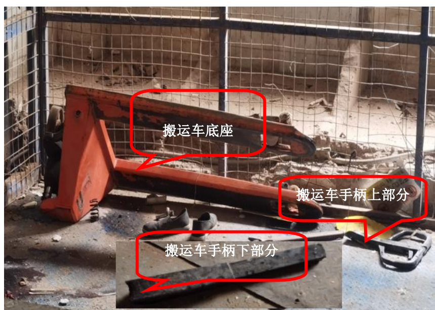
图 11 涉事搬运车在卡住工作台后被拆除的情况
