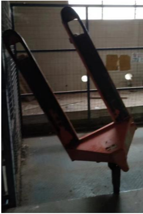
图 2 搬运车手柄卡住工作台故障
