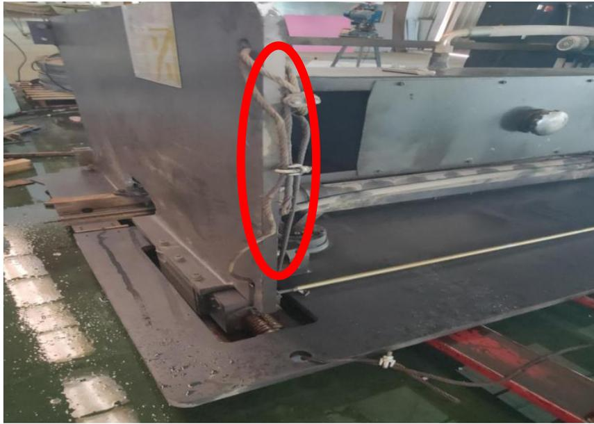
图 7. 用于正常吊运设备顶部的钢丝绳
