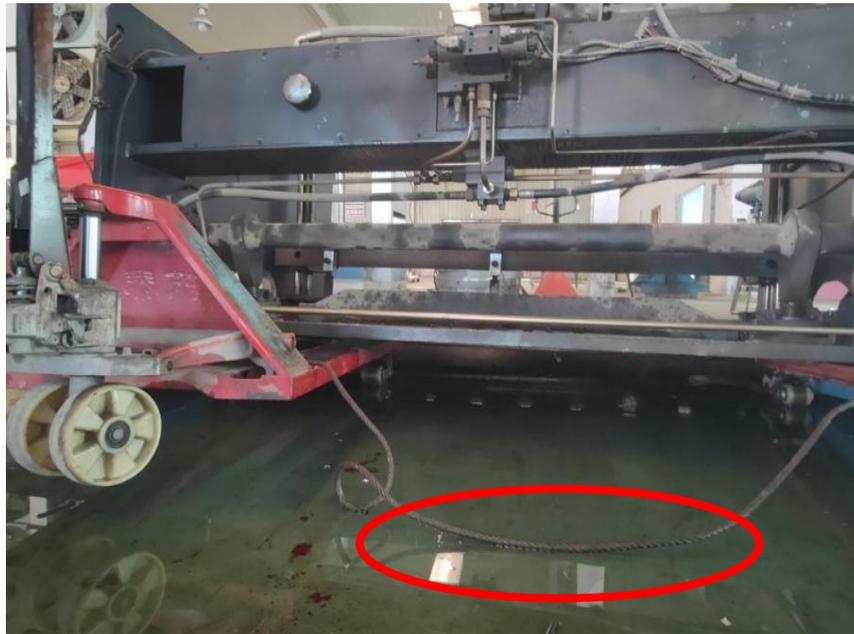
图 6. 用于正常吊运设备顶部的钢丝绳
